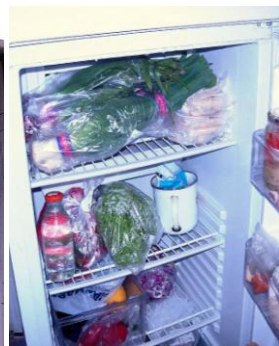
Heladera a biogás
